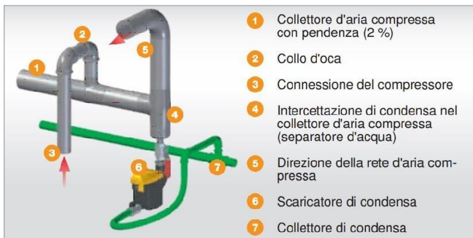
Fig. 3: Separatore d'acqua con scaricatore di condensa lungo una linea non trattata del circuito d'aria compressa
